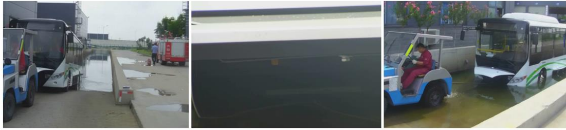
整车断电后进入浸水池
