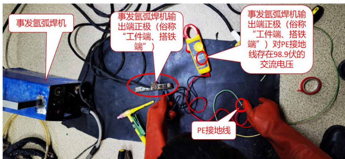
图 18 事发氩弧焊机输出端正极带电检测情况图
