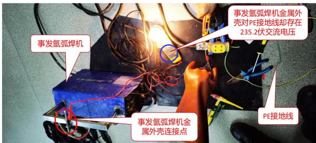
图 24 事发氩弧焊机输出端正极（俗称“工件端、搭铁端”）对 PE 接地线存在 234.7 伏的交流电压
