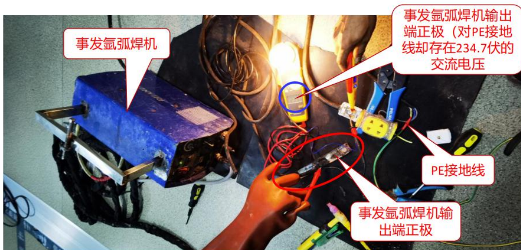
图 24 事发氩弧焊机输出端正极（俗称“工件端、搭铁端”）对 PE 接地线存在 234.7 伏的交流电压
