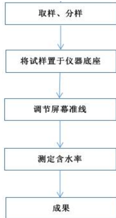
图1 液塑限联合测定试验流程图
